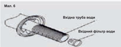
2) За допомогою пробки фільтра (модель нижнього вхідного потоку) відповідно до (Мал. 6), витягніть вхідний фільтр і очистіть, як показано на (Мал. 5).
